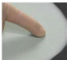
Le Micro-porosità sono spesso invisibili e possono causare difetti di verniciatura.
