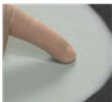
Los micro-poros son casi invisibles y a menudo conducen a defectos de pintura
